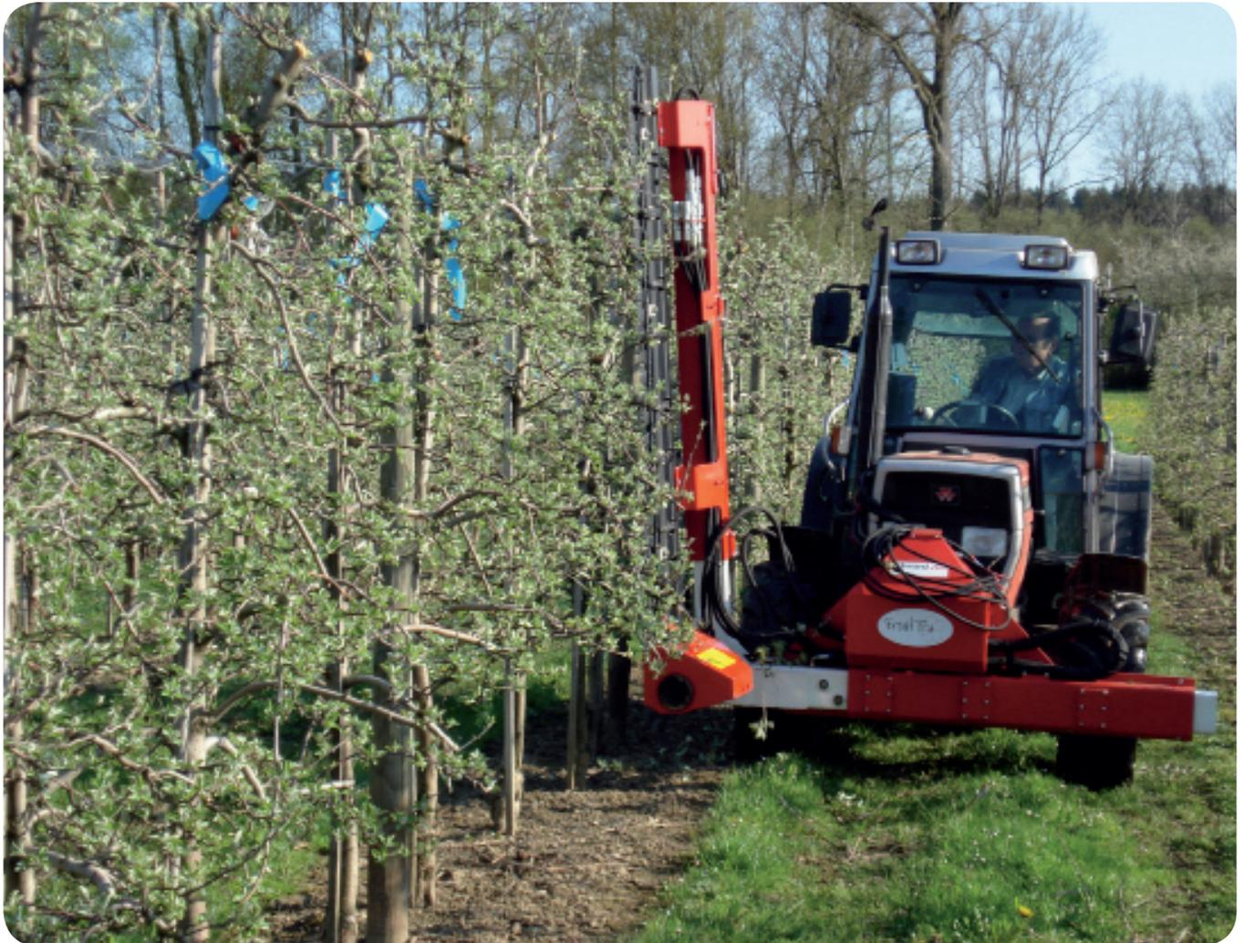
IM VERSUCH WURDEN die Apfelbäume nur seitlich maschinell geschnitten. Die Korrektur am Kopf erfolgte von Hand.
