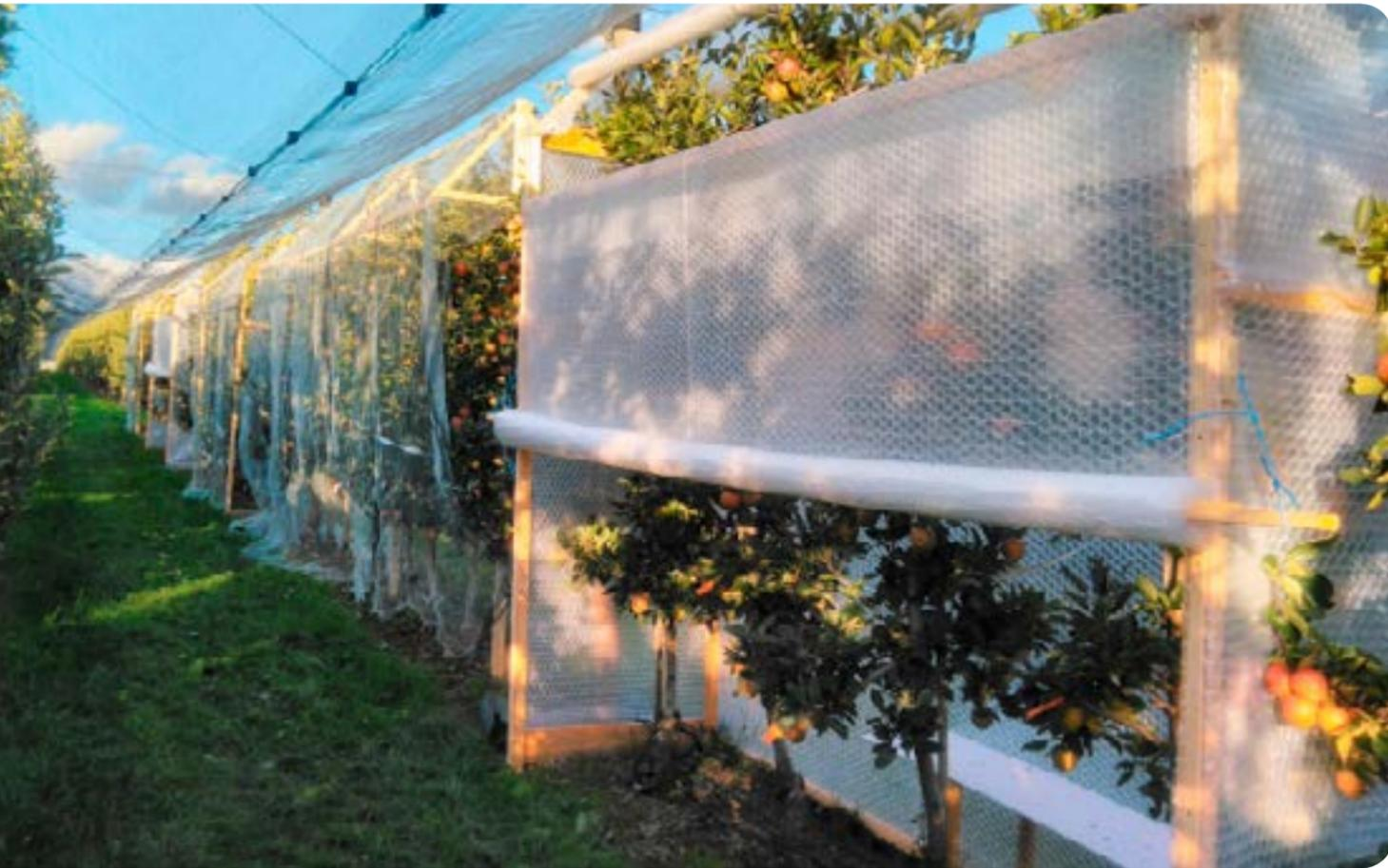
VERSUCHSANLAGE, MIT DER Daten zur Prognose der Lagereignung erhoben werden. Hier werden unterschiedliche Temperaturen im Feld erzeugt.
